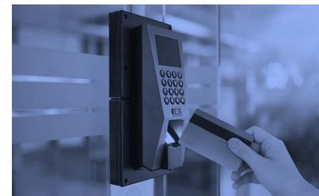
Sistem de control acces bazate pe identificarea amprentei digitale, cardurilor RFID sau codurilor unice de acces, recomandat pentru acces in imobile de birouri, fabrici, depozite, hoteluri. etc
