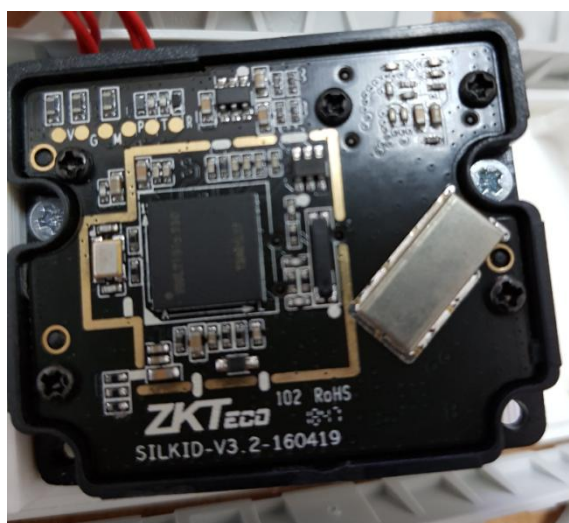
Fig. 13 - placa de circuit a cititorului de amprente
