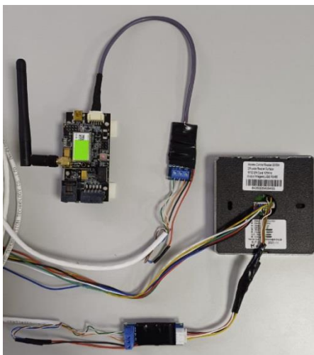
Fig.19 Conexiunile modulelor bluetooth la unitatea centrala prin intermediul modulelor de conversie de la TTL la RSRS485
