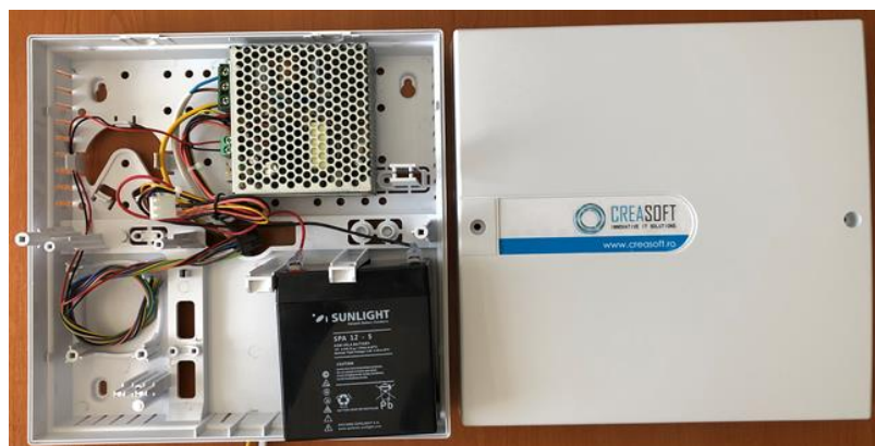
Fig.14 Amplasarea sursei de alimentare în comutație și a acumulatorului în cutia sursei
